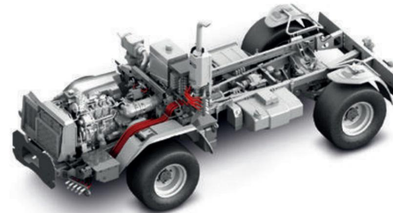
**Arbeitshydraulik mit Verstellpumpe**
