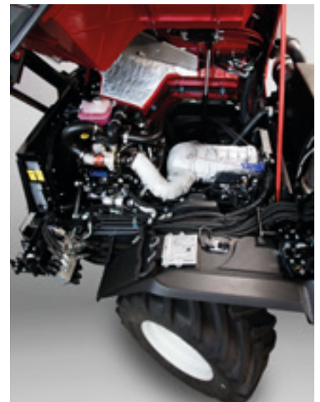
Sauber, kompakt, hohes Drehmoment: der Perkins-Synchro-Motor
