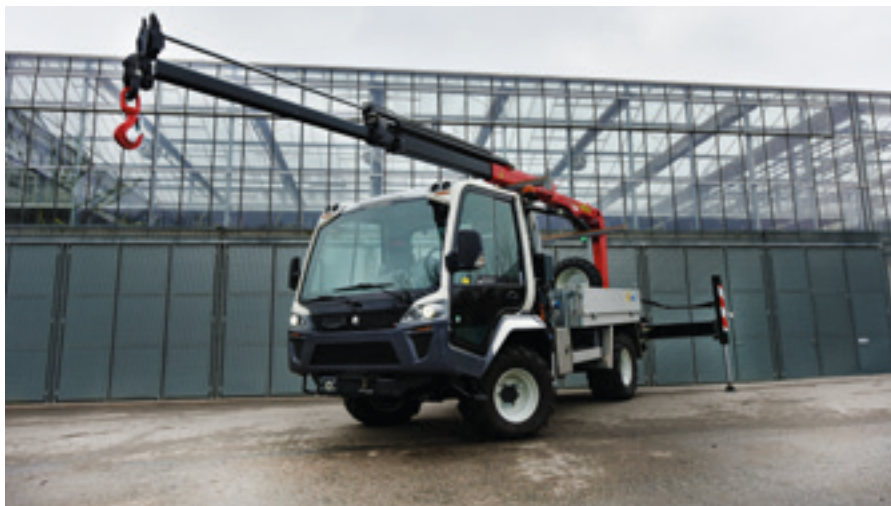
Hält das Luzerner Stromnetz in Schuss: Unitrac 112 mit Winde und Kran
