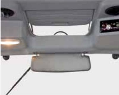
Mit dem innovativen **Frontlader-Freisicht-Fenster** erreicht der GEOTRAC 94 ein großes Sichtfeld bei Frontladerarbeiten. Der **integrierte Sonnen-Schieber** schützt vor direkter Lichteinstrahlung.
