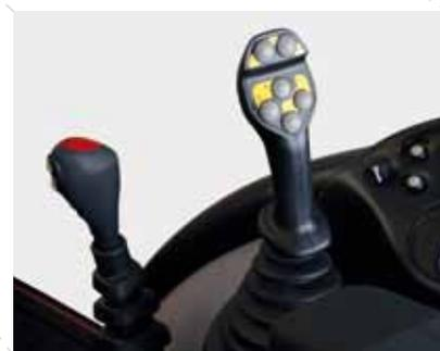
Der optionale **Multicontroller** dient zur Bedienung von Frontlader, Hydraulik und Power-Shuttle. Über Mikroschalter kann zwischen den verschiedenen Hydraulik-Funktionen gewechselt werden.
