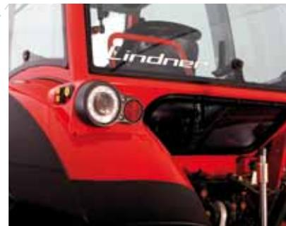
Serienmäßig ist die **beidseitige Fernbedienung** von Zapfwelle und Heckhydraulik. Durch das **Heck-Schiebefenster** sind die Hydraulikanschlüsse und der Anhängelbolzen bequem zu erreichen.
