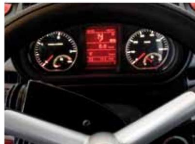
Auf dem **Zentralinfoboard mit I.B.C.-Display** sind alle Fahrzeuginformationen übersichtlich dargestellt. Neben Drehzahlen und Geschwindigkeiten kann eine Vielzahl von Funktionen abgerufen werden. Per Knopfdruck auf dem Shuttle-Hebel wird zwischen Tagesbetriebsstunden-, Batteriespannungs- oder **Verbrauchsanzeige** gewechselt.
