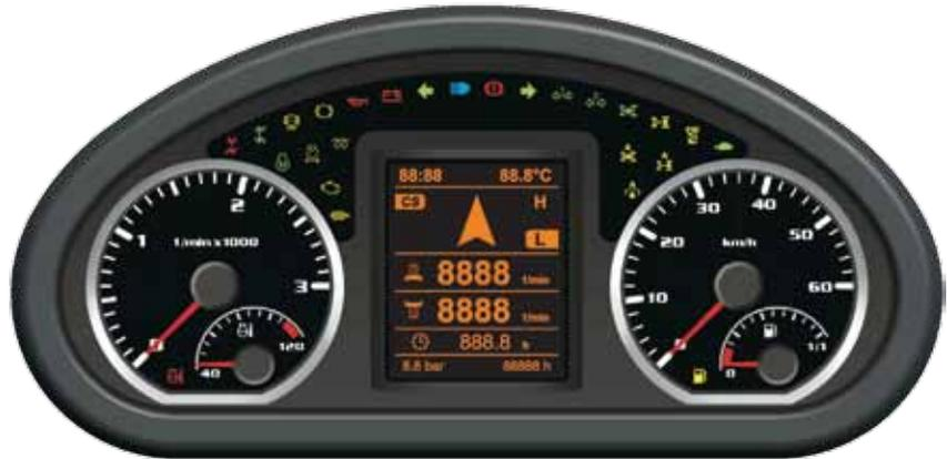
Über das **Zentralinfoboard** mit I.B.C.-Display (Intelligenter-Bord-Computer), das im **GEOTRAC 94** zum Serienumfang gehört, kann eine Vielzahl von Funktionen angezeigt und bedient werden. Neben den Hauptinformationen, wie Drehzahlen, Geschwindigkeit, Kontrollanzeigen und Uhrzeit,
