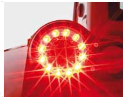
**LED-Rücklichter** - Mit der extrem langen Lebensdauer der Leucht-Dioden von bis zu 20.000 Stunden, halten Rück- und Bremslichter praktisch ein Traktorleben lang und sind dadurch wartungsfrei.
