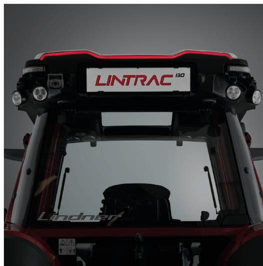
Auf Wunsch sind leuchtstarke H7-Halogen oder LED-Arbeitscheinwerfer erhältlich. Für den Kommunaleinsatz kommen extrem gut sichtbare LED-Rundumleuchten und Blitzbalken zum Einsatz. Um auf besondere Einsätze aufmerksam zu machen kommen LED-Blitzleuchten zum Einsatz die sich perfekt in die TracLink-Dachschale einfügen – ohne Nachteile für die Bauhöhe.
